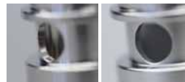
Пример: до, с заусенцем и после, полностью без заусенца
