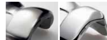
Пример: отполированная поверхность, Ra 0.01 μm
